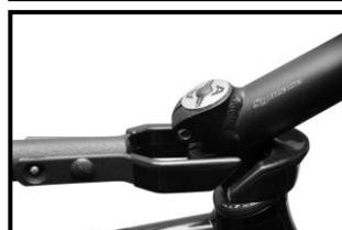
Schuif de stang uit totdat de grote haak rond de stuurpen kan worden geplaatst en draai de sluiting weer dicht.
